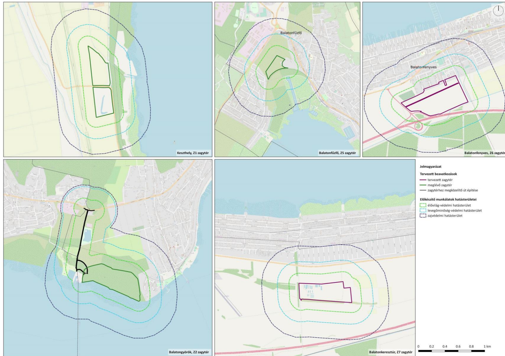
11. ábra Az előkészítő munkák, azaz a zagyterek kialakítása és reaktíválása hatásterülete
